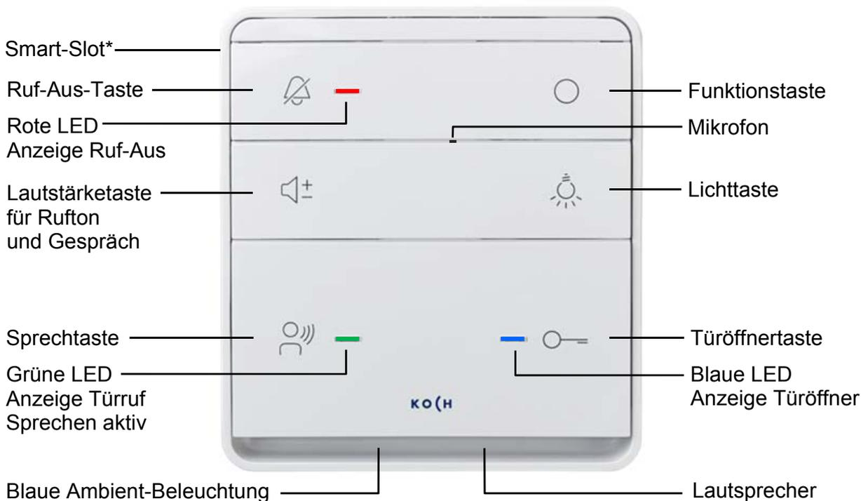
\*Smart-Slot = Einschub-Schnittstelle für Funktionserweiterungen (z.B. Funkgong)
