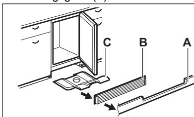
2. Reinigen Sie das Lüftungsgitter.
