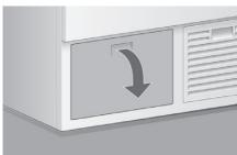
▶ Öffnen Sie die Wartungsklappe.
