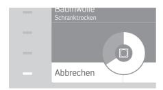
Drücken Sie so lang auf den Leuchtbalken bei **Abbrechen**, bis **Ende** angezeigt wird.
