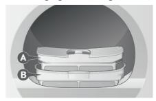
Reinigen Sie Filter A und B regelmässig.
