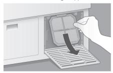
► Entnehmen Sie den Luftfilter D, indem sie ihn leicht nach oben schieben und dann schräg nach unten wegziehen.
