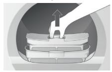
Entnehmen Sie den inneren Filter A und klappen Sie ihn auf.
